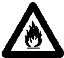
Matières inflammables ou haute température (1)
