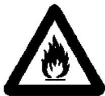
Matières inflammables ou haute température (1)
