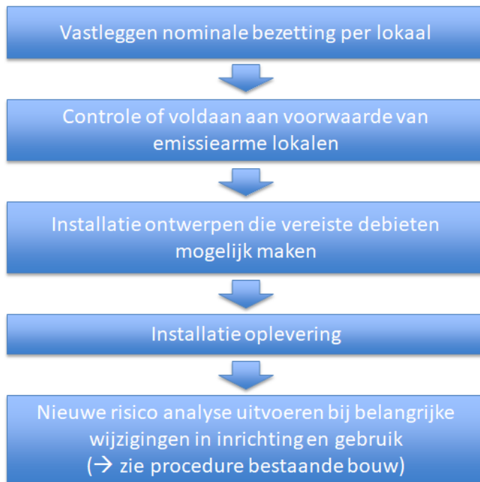
Figuur 3: Belangrijkste stappen voor het ontwerp en de bouw van een nieuw gebouw.
