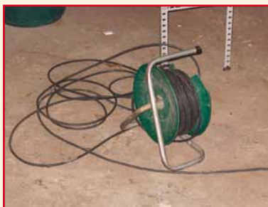
Illustration 23 : lorsque vous utilisez une rallonge, ne réparez jamais le cordon avec du ruban adhésif (à gauche) et veillez toujours à dérouler complètement le cordon (à droite)
