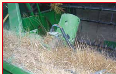
Illustration 43 : tête de coupe d'une moissonneuse-batteuse sans protection
