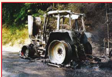
Illustration 42 : une protection contre la surcharge sur un hacheur (à gauche) permet d'éviter qu'une machine ne prenne feu et ne s'embrase totalement (à droite)
