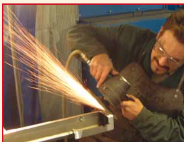
Illustration 35 : le meule qui ponce sur une surface métallique produit des étincelles (à gauche), les toiles de soudage installées dans un atelier offrent une protection (à droite)
