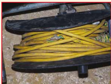
Illustration 23 : lorsque vous utilisez une rallonge, ne réparez jamais le cordon avec du ruban adhésif (à gauche) et veillez toujours à dérouler complètement le cordon (à droite)
