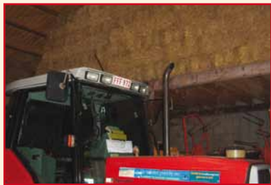
Illustration 41 : entreposage d'engins agricoles avec moteur à combustion et matériaux inflammables dans le même espace à une distance proche
