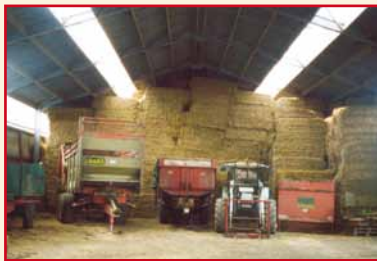
Illustration 41 : entreposage d'engins agricoles avec moteur à combustion et matériaux inflammables dans le même espace à une distance proche
