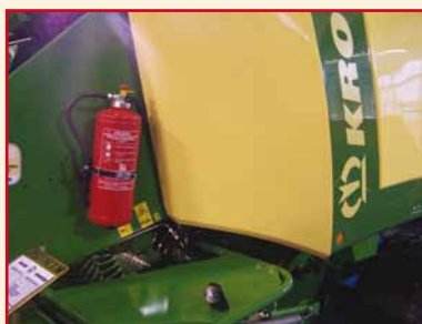
Illustration 52 : un extincteur sur une machine agricole doit être accessible (à gauche), la date limite de validité doit être indiquée sur l'appareil (à droite)
