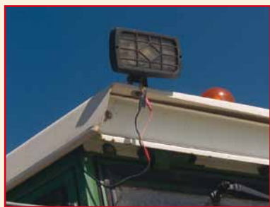
Illustration 19 : un câble défectueux sur un tracteur (à gauche) ou un câble dans une flaque d'eau (à droite) peut provoquer un court-circuit
