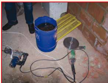
Illustration 22 : un cordon qui traîne dans l'atelier présente un risque d'incendie (à gauche) et le fait de tirer une fiche par le cordon peut causer des dégâts (à droite).
