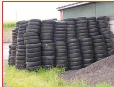
Illustration 40 : un entreposage ordonné des pneus de voiture réduit considérablement le risque d'incendie
