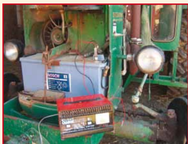
Illustration 24 : il est important de procéder à la recharge d'une batterie de tracteur (à gauche) ou d'une machine de brosse (à droite) en toute sécurité
