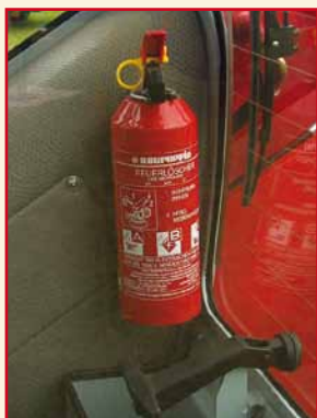
Illustration 54 : un petit extincteur à poudre (1 kg) suspendu dans un chargeur frontal, un extincteur à poudre plus grand suspendu au mur
