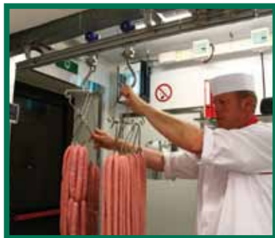
L'emploi d'un rail facilite le transfert des produits du camion vers la chambre froide
