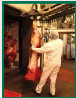
L'emploi d'un rail facilite le transfert des produits du camion vers la chambre froide
