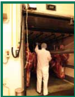
L'emploi d'un rail facilite le transfert des produits du camion vers la chambre froide
