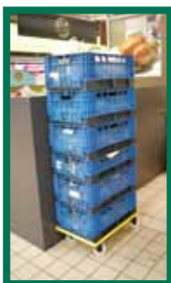
L'utilisation de plateaux sur roulettes et autres aides techniques facilitent le déplacement des bacs empilés, plateaux ...
