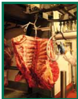
L'emploi d'un rail facilite le transfert des produits du camion vers la chambre froide
