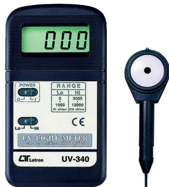
Toestel 'UV-340' dat ultraviolette straling meet tussen golflengtes 290 nm - 390 nm (UVA/UVB)
