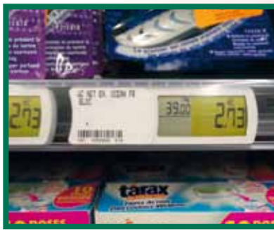
De manuele handeling om prijzen aan te passen op etiketten kan vervangen worden door elektronische etiketten die aangepast worden via RF
