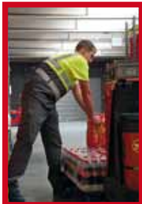
Gemechaniseerde aanpassing van de hoogte van het werkvlak
