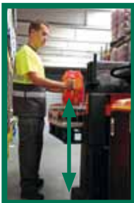
Gemechaniseerde aanpassing van de hoogte van het werkvlak
