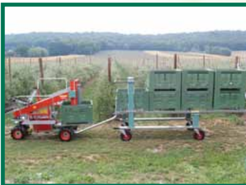
Door het mechaniseren van de verplaatsing van pallboxen worden krachtinspanningen die gepaard gaan met een manuele verplaatsing vermeden
