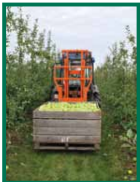
Door het mechaniseren van de verplaatsing van pallboxen worden krachtinspanningen die gepaard gaan met een manuele verplaatsing vermeden
