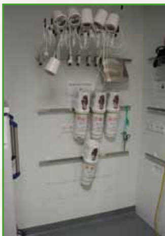
Stockage van zuurstofflessen door ze aan muursteunen op te hangen i.p.v. op de vloer
