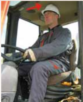
Onvoldoende afstand tussen het hoofd van de persoon en het plafond van de cabine
